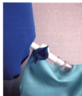
(Abb. 2) Ablassen des Granulates bei geöffnetem Drehventil (blau)
